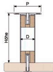
**Barstützen mit verdeckter Befestigung** für Barplatten aus Holz oder Stein
