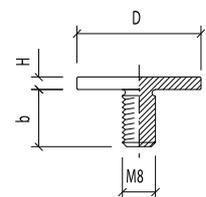
**Glasbefestigungen Vierkant Chromstahl** mit Gewindestift und Zentrierplatte zum Schrauben
