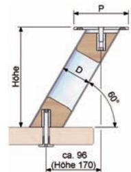
**Barstützen schräg mit Platte zum Schrauben / Kleben** für Barplatten Holz / Stein
