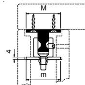
Alle Tischfüsse **inklusive Befestigung Fixissimo®**. Systembeschreibung siehe Register 5.**Tischfüsse 100x100 mit verdeckter Befestigung (innenliegend)** (FIXISSIMO Typ H-100)Für **eckbündige** Montage. Die Grundplatte 72 x 72 mm ist im Fuss eingelassen.
