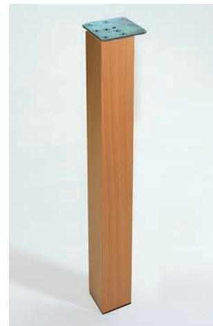
**Tischfüsse 60x60 mit verdeckter Befestigung (exzentrisch)** (FIXISSIMO Typ VE-60)Für **eckbündige** Montage. Die Grundplatte 92 x 92 mm wird in der Tischplatte eingelassen.
