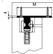
Alle Tischfüsse **inklusive Befestigung Fixissimo®**. Systembeschreibung siehe Register 5.**Tischfüsse 80x80 mit verdeckter Befestigung (exzentrisch)** (FIXISSIMO Typ HE-80)Für **eckbündige** Montage. Die Grundplatte 110 x 110 mm wird in der Tischplatte eingelassen.
